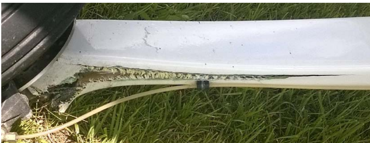
Rys. 14. Zdjęcie uszkodzonej goleni podwozia głównego samolotu 3Xtrim 450 [12]
